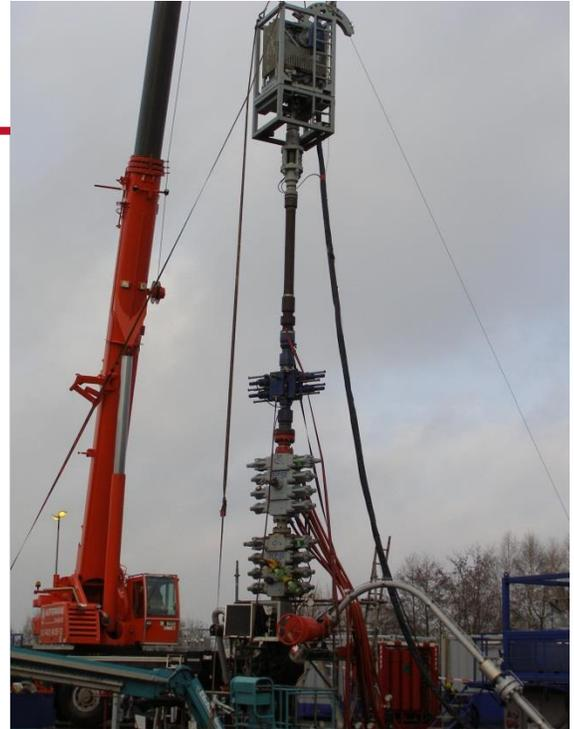
El sistema Renaissance WDCL de Weatherford reemplazó eficientemente una TRSSSV dañada en un pozo amargo. Usando equipos que pueden soportar las condiciones corrosivas dentro del pozo, esta operación ayudó al cliente a evitar grandes intervenciones y al mismo tiempo restableció la producción a niveles óptimos.
